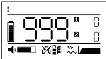
Fig. 6: Sistema com auscultadores sem fios F8 pronto a funcionar (símbolo da bateria para auscultador visível)
